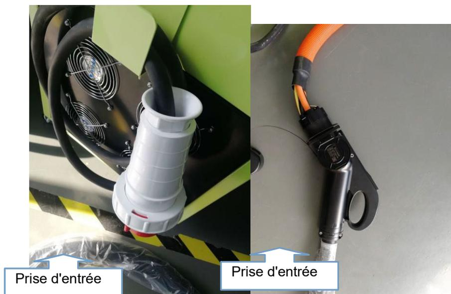
Alimentation de l'interrupteur d'air d'entrée CA. L'entrée est une prise Yida et la sortie est un pistolet de charge. **Avertissement : La protection PE de la terre doit être connectée, sinon elle peut menacer la sécurité des personnes.**
